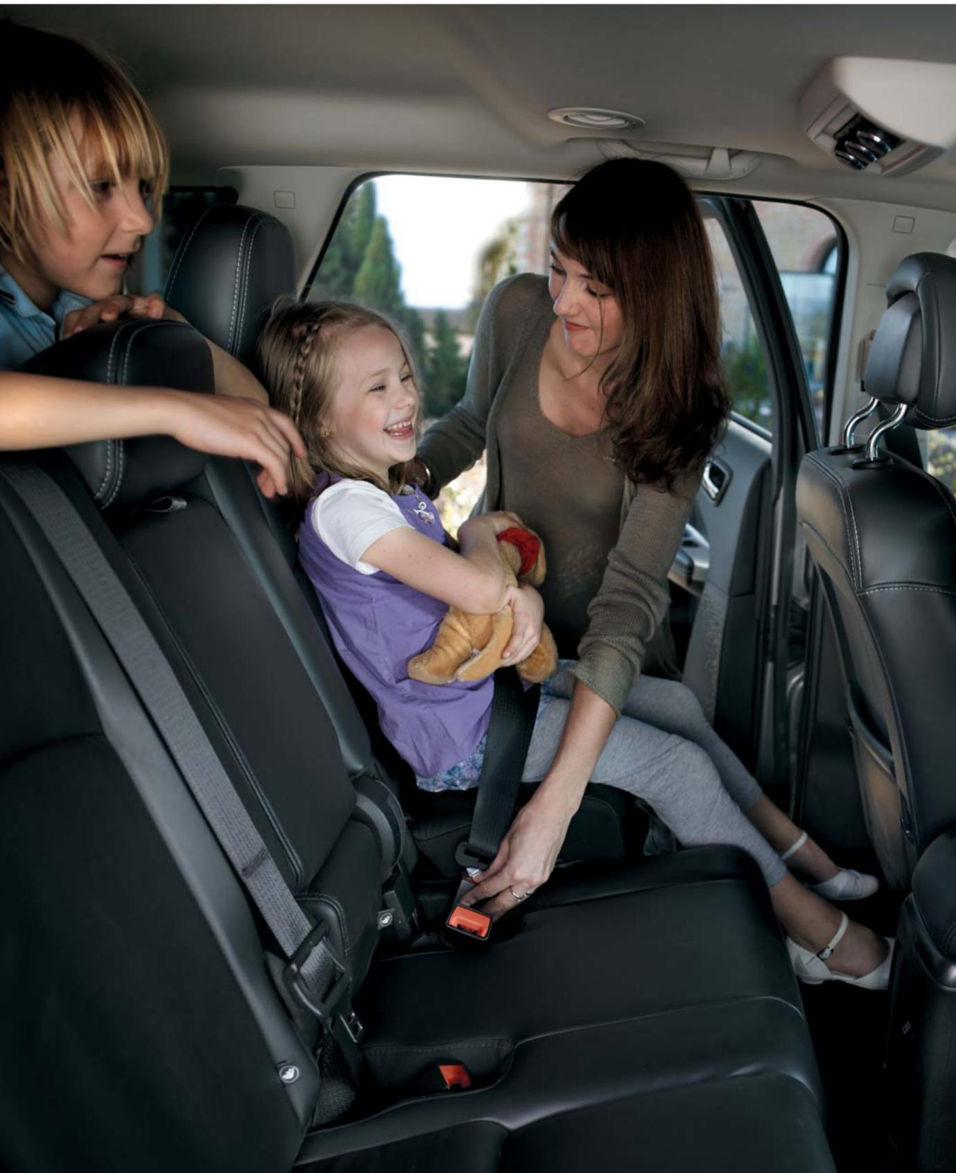
È facile sentirsi accolti e protetti su Freemont: l'apertura a 90° delle portiere e il semplice sistema di scorrimento longitudinale indipendente (60/40) della seconda fila di sedili agevolano l'accessibilità all'interno, mentre i due "child booster" integrati nella seconda fila permettono la corretta seduta dei bambini, garantendo maggiore protezione, praticità e comfort.
