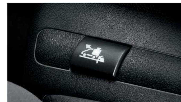
Pulsante in plancia della funzione Up per ottimizzare il cambio marcia a pieno carico.
