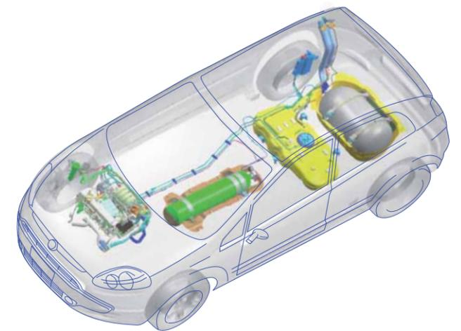
■ Schema disposizione serbatoi e motore.
