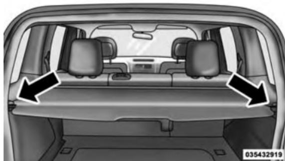
**Posizionamento copertura vano di carico a scomparsa**
