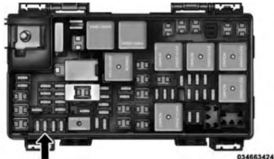
**Posizione del fusibile presa di corrente**
