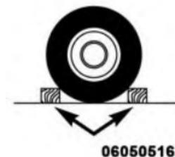
6. Bloccare la ruota diagonalmente opposta a quella da sostituire. Bloccare ad esempio la ruota posteriore sinistra se si deve sostituire quella anteriore destra.
