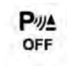
Premendo l'interruttore del sistema ParkSense® per disabilitarlo, sul quadro strumenti viene visualizzato il messaggio "PARK ASSIST OFF" (Sistema di assistenza parcheggio disabilitato) per circa cinque secondi. Vedere "Check panel (EVIC)" in "Descrizione plancia portastrumenti" per ulte-
