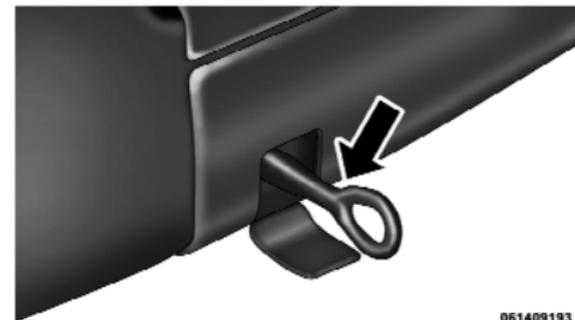
**Attacco per il traino posteriore montato**
