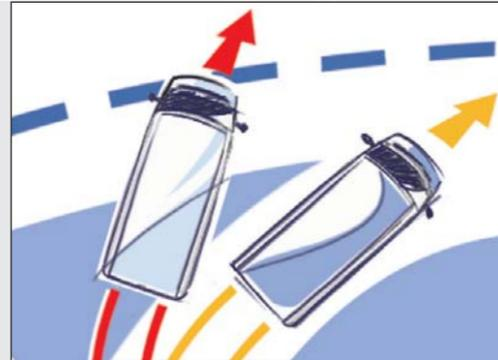
● Il sistema impedisce il bloccaggio di una o più ruote durante una frenata di emergenza, permette di sfruttare la massima aderenza possibile evitando la perdita di controllo del mezzo.
