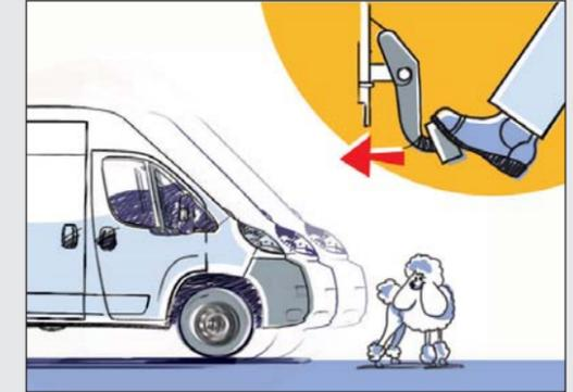
● Incrementa automaticamente la pressione del circuito frenante durante una frenata d'emergenza, consentendo la riduzione degli spazi d'arresto, agendo direttamente sul servofreno. Se il veicolo è dotato di ESP, analoga funzione è svolta dall'HBA (Hydraulic Brake Assistance).
