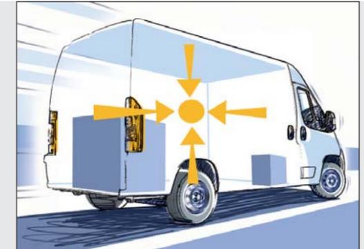
● Il sistema è integrato nell'ESP e ha la funzione di identificare le condizioni di carico del veicolo durante la marcia, in particolare la massa totale e la posizione del baricentro. Al variare di questi parametri, interviene calcolando e comunicando nuove tarature e nuove soglie di intervento alle funzioni ABS, ASR ed ESP, che possono così funzionare sempre con la massima efficienza.
