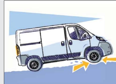
● Il sistema contrasta gli effetti dello slittamento di una o di entrambe le ruote motrici in condizioni di scarsa aderenza, intervenendo sui freni o riducendo temporaneamente la potenza erogata dal motore.
