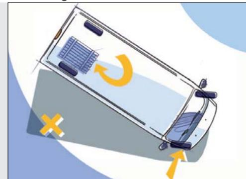
● Il sistema interviene in situazioni di emergenza, come ad esempio manovre di scarto improvvise per evitare un ostacolo. Effettua il monitoraggio di parametri quali l'accelerazione laterale, la velocità, l'aderenza a terra e l'angolo del volante. Elabora i dati e, se necessario, interviene sulla coppia motrice e sull'impianto frenante per riportare il veicolo in condizioni di perfetta stabilità.
