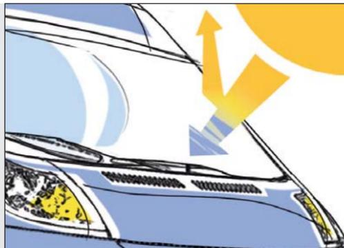
● Il parabrezza contiene al suo interno un sottile strato di ossidi metallici, che intercetta e riflette i raggi infrarossi responsabili del surriscaldamento dell'abitacolo. Riduce l'effetto bruciante del sole sugli occupanti e la temperatura all'interno dell'abitacolo, con relativa diminuzione dell'uso dell'aria condizionata e quindi anche dei consumi.
