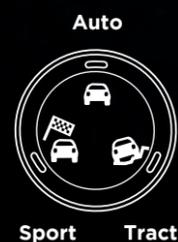
**Il Drive Mode Selector** permette al conducente di selezionare, una delle tre "modalità" disponibili che ottimizzano la dinamica di guida adattando il comportamento della vettura. È standard sui motori 4x4 nelle versioni City Cross/Cross.
