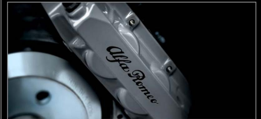
Freni anteriori dual-cast autoventilanti forati 305x28 con pinza fissa a 4 pistoncini Brembo
