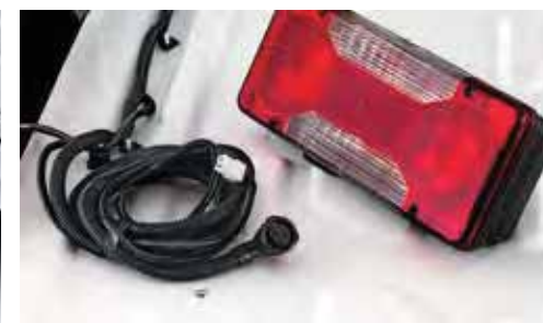
Predisposizione fanaleria con cavo ricco in lunghezza e fanaleria posteriore (opt. 4EA)
