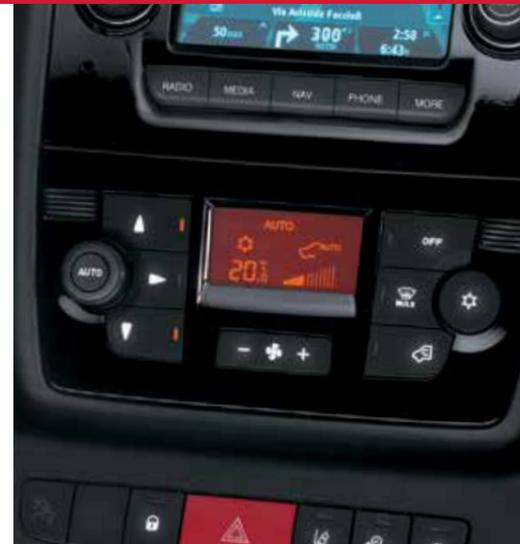
**Webasto.** Grazie al riscaldatore programmabile Webasto Thermo Top "C", è possibile il riscaldamento del veicolo fino a 24 ore prima della partenza. Può funzionare anche istantaneamente, riscaldando la cabina, il motore e sbrinando i vetri. Il sistema, inoltre, è completamente indipendente dal motore. Il Webasto è disponibile anche in versione automatica priva di timer.
