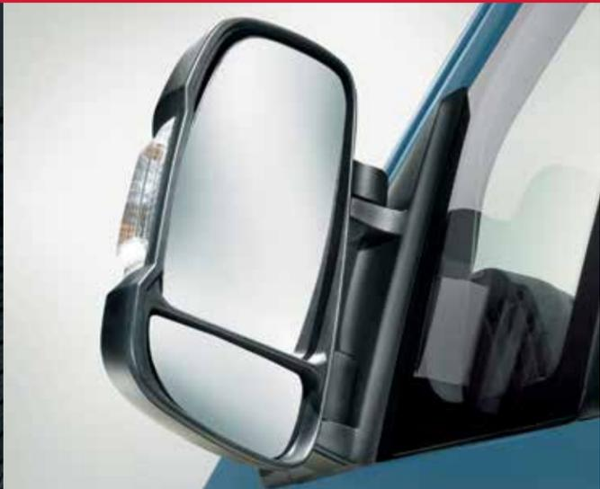
**Specchietti regolabili ed abbattibili elettricamente.** Gli specchi retrovisori a doppia parabola di Ducato garantiscono una visione posteriore panoramica unita alla massima praticità di utilizzo, in quanto possono essere regolabili ed abbattibili elettricamente dall'interno. Entrambe le parabole sono regolabili indipendentemente per adattarsi a tutti gli utenti.
