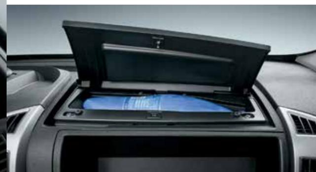
Il vano refrigerato mantiene freschi alimenti e bevande quando l'aria condizionata è in funzione.
