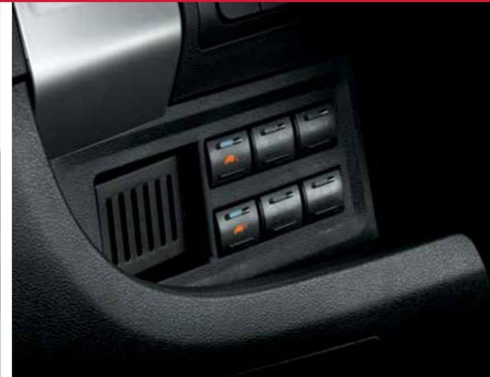
**Sospensioni pneumatiche.** Le sospensioni pneumatiche permettono di mantenere stabile l'assetto del veicolo in marcia con ogni condizione di carico. A veicolo fermo è possibile aumentare o diminuire l'altezza da terra per agevolare il carico delle merci.
