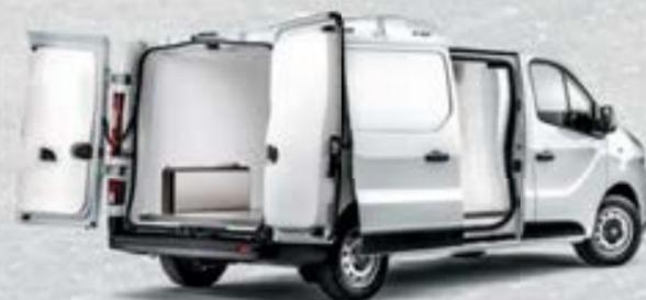
Veicolo coibentato isotermico, omologato A.T.P. può mantenere temperature interne costanti fino a 0°C. Con l'applicazione di un gruppo refrigerante, la cella si trasforma in una cella frigorifera idonea per il trasporto di farmaci o alimenti.
