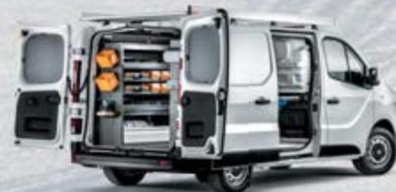
Allestimento realizzato in acciaio automotive galvanizzato con sistema di fissaggio rapido modulare e flessibile.
